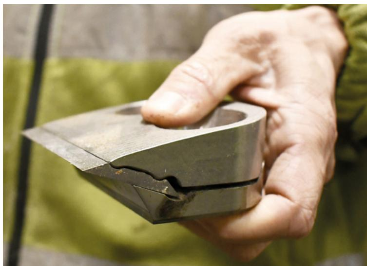
Sorgt für ein rasches Wechseln der Messer: das Turnknife-System von Andritz an den Powerhead-Scheiben
