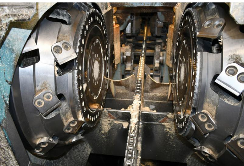
Im Norra Timber-Sägewerk Kåge sind zwei Paar Powerhead-Spanerscheiben von Andritz im Einsatz
